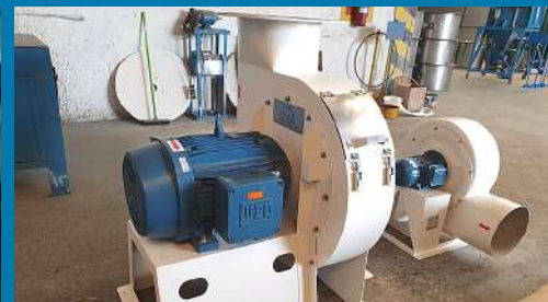
Exaustor Gases Corrosivos
